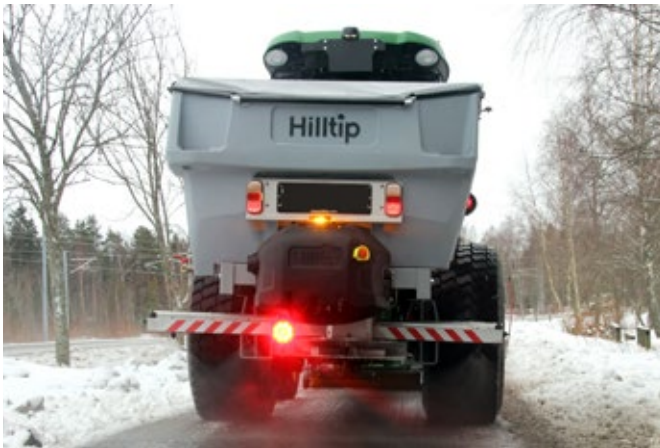
LED Arbeitsscheinwerfer (rot) und Warnlicht (orange)
