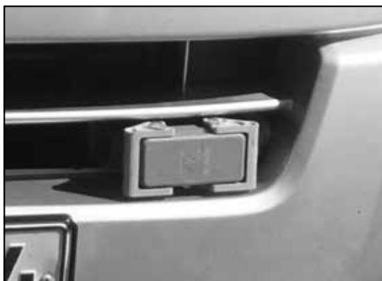
2. Befestigen Sie das Steckverbinder-Set tief in den Stoßfänger hinein, damit es weniger sichtbar ist
