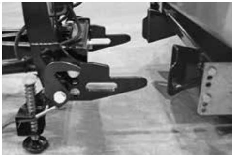
**1** Der Pflug muss mit herabgelassenen Gleitschuhen stabil auf dem Boden stehen
