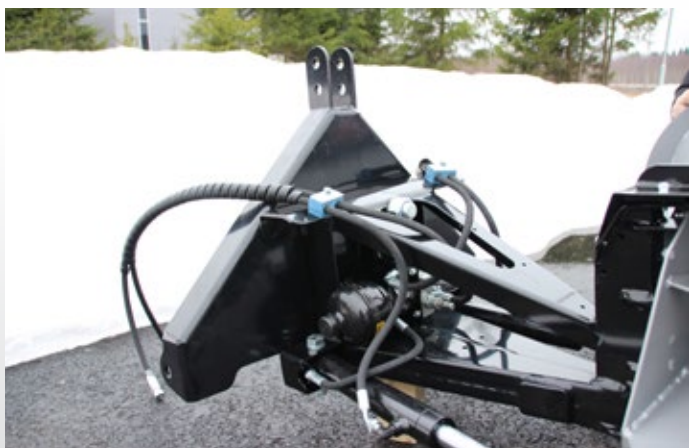
Abgebildet Dreipunktaufnahme mit Niveaueingleich
