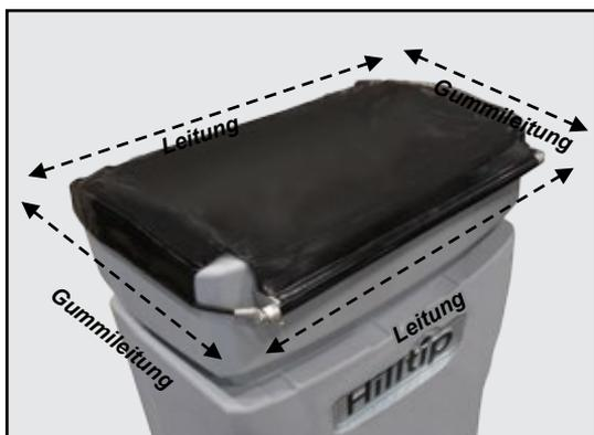
**5.** Führen Sie die Leitungen in die beiden längeren Öffnungen ein. Führen Sie die Gummileitungen in die beiden kürzeren Öffnungen ein und verbinden Sie die Enden mit einem Bolzen mit der Leitung.
