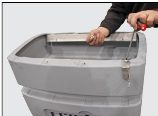
**4.** Tragen Sie das Schmiermittel auf die Schrauben und Muttern auf und befestigen Sie die vier Halterungen an allen Ecken des Behälters. Legen Sie den oberen Bildschirm zurück und befestigen Sie ihn mit Schrauben.
