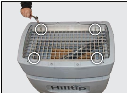
**1.** Der obere Bildschirm ist vormontiert. Lösen und entfernen Sie alle vier Muttern.
